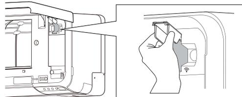
4. Remova o adaptador WLAN da ranhura de ligação da unidade interior na direção que se mostra na figura.
