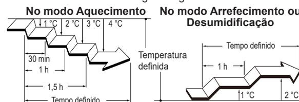
Depois de o tempo definido terminar, o funcionamento do aparelho de ar condicionado é desligado.
