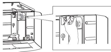
4. Remova o adaptador WLAN da ranhura de ligação da unidade interior na direção que se mostra na figura.
