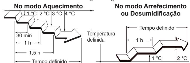
Depois de o tempo definido terminar, o funcionamento do aparelho de ar condicionado é desligado.
