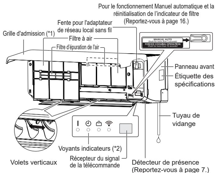
\*1 : Avant de démarrer l'appareil, vérifiez que la grille d'admission est complètement fermée. Une fermeture incomplète risque d'affecter le bon fonctionnement ou les performances de l'appareil.
