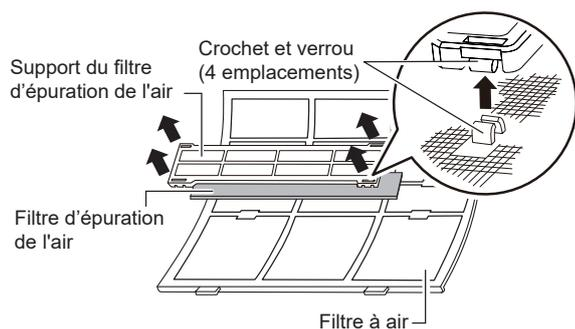
3. Placez un filtre d'épuration d'air (neuf ou nettoyé) sur le filtre à air.
