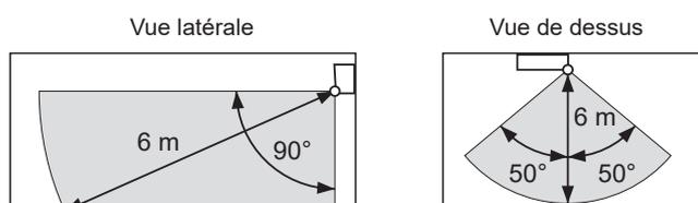
**REMARQUE :** Le détecteur de présence détecte la lumière infrarouge émise par les êtres humains, la détection peut s'avérer incorrecte dans les situations suivantes.
