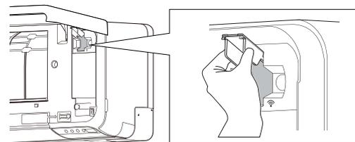
4. Retirez l'adaptateur de réseau local sans fil de la fente de connexion de l'unité intérieure dans le sens indiqué sur la figure.
