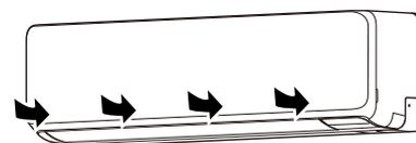
**REMARQUE** : Si de la saleté s'accumule sur le filtre à air, cela réduit le flux d'air, l'efficacité de fonctionnement diminue et le bruit augmente.
