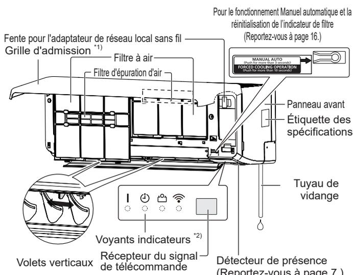
\*1) Avant de démarrer l'appareil, vérifiez que la grille d'admission est complètement fermée. Une fermeture incomplète risque d'affecter le bon fonctionnement ou les performances de l'appareil.
