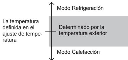
Al seleccionar modo Automático por primera vez, el ventilador funcionará a velocidad muy baja durante unos minutos, mientras la unidad interior determina las condiciones de la habitación y selecciona el modo de funcionamiento adecuado.
