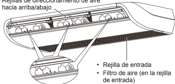
Rejillas de direccionamiento de aire hacia la izquierda/derecha\* (detrás de las rejillas de direccionamiento de aire hacia arriba/abajo)
