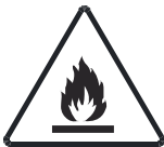
Precaución: Riesgo de incendio
