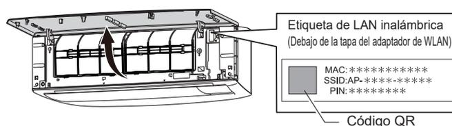
\*La disposición de la etiqueta de la LAN inalámbrica puede variar según la pieza o el modelo.
