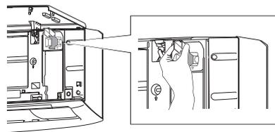
4. Retire el adaptador de WLAN de la ranura de conexión de la unidad interior en la dirección que se muestra en la figura.
