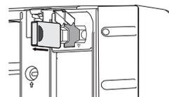
5. Cierre la cubierta del adaptador WLAN y la rejilla de entrada.
