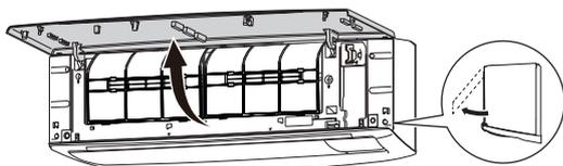
3. Abra la cubierta del adaptador WLAN hasta oír un chasquido.
