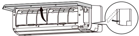
3. Abra la cubierta del adaptador WLAN hasta oír un chasquido.
