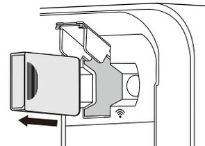
5. Cierre la cubierta del adaptador WLAN y la rejilla de entrada.
