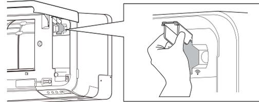
4. Retire el adaptador de WLAN de la ranura de conexión de la unidad interior en la dirección que se muestra en la figura.
