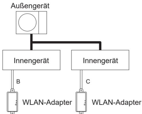
A, B und C sind an diesem Produkt angeschlossene Adapterkabel.
