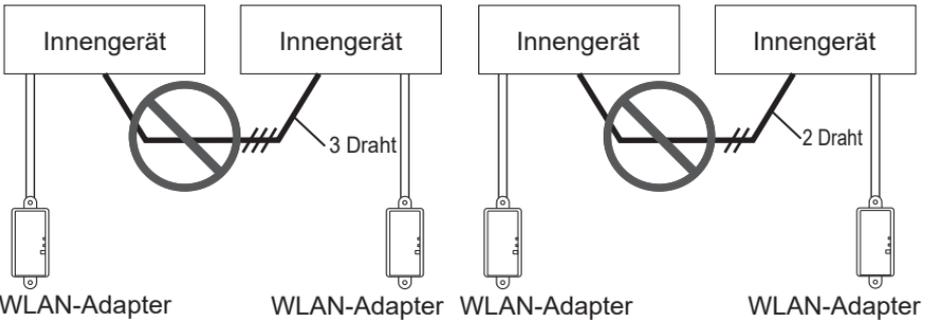
(3) Gruppenverbindung von Innengeräten mit WLAN-Adapterkabel.
