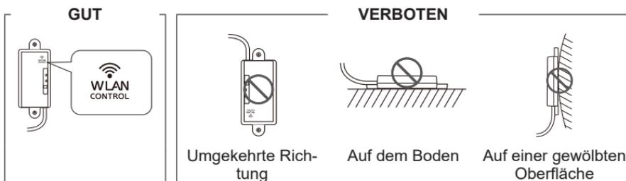
Legen Sie das WLAN-Adapterkabel nicht auf den Boden. Sie können über die Kabel stolpern.
