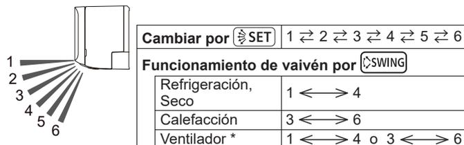
\* El rango del funcionamiento de vaivén depende de la dirección de flujo de aire establecida antes del funcionamiento de vaivén.
