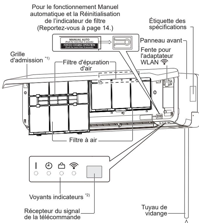
\*1) Avant de démarrer l'appareil, vérifiez que la grille d'admission est complètement fermée. Une fermeture incomplète risque d'affecter le bon fonctionnement ou les performances de l'appareil.
