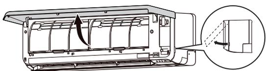
3. Ouvrez le capot de l'adaptateur WLAN jusqu'à ce qu'il s'enclenche.
