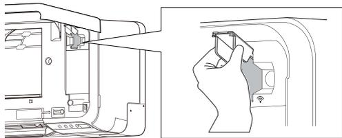
4. Branchez l'adaptateur WLAN dans la fente de connexion de l'unité intérieure dans le sens indiqué sur la figure.
