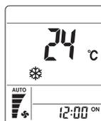
Pulse el botón “+” y “-” una vez para aumentar o disminuir el ajuste de tiempo en 1 h. Pulse el botón “+” o “-” durante 2 segundos para aumentar o disminuir el ajuste de tiempo en 10 minutos.
