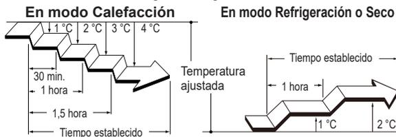
Una vez transcurrida la hora configurada, el acondicionador de aire se apaga.
