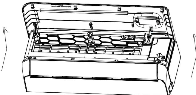
2. Quite la cubierta de Wi-Fi de USB, siga la flecha e inserte el módulo Wi-Fi de USB en la ranura reservada de USB del marco.
