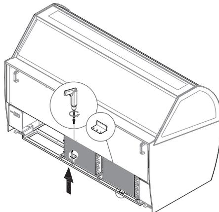
Remover las abrazaderas de fijación como se indica.
