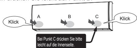
Wenn das Einlassgitter vollständig geschlossen ist, funktioniert die Klimaanlage nicht und die Lampe blinkt wie unten abgebildet.
