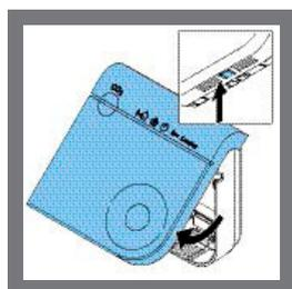
1. Presionar el clip y tire de la sección superior de la sección inferior.
