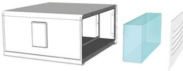
5 - Para acceder al filtro absoluto, desmontar el panel de salida de aire desatornillando los 6 tornillos correspondientes. Este panel presiona perimetralmente el filtro para conseguir la estanqueidad deseada.
