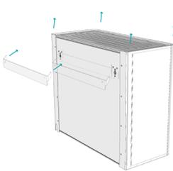
1- Descolgar de la pared el equipo, elevándolo ligeramente para sacar los enganches de la pieza de anclaje a pared del equipo.
