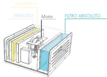
2 - Colocarlo en posición horizontal, apoyado sobre una superficie estable, e identificar los filtros antes de realizar cualquier acción.
