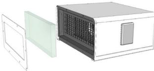
3- Para acceder al prefiltro, desmontar el panel de entrada de aire desatornillando los 6 tornillos correspondientes.
