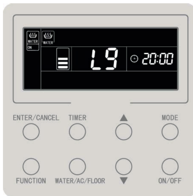
Figure 5.1 Erreur de nombre inconsistant de réservoirs d'eau ou chauffe d'eau dans un système un-contrôle-plusieurs lorsque l'unité est en marche
