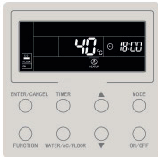
Chauffage plancher en marche avec temporisateur non réglé
