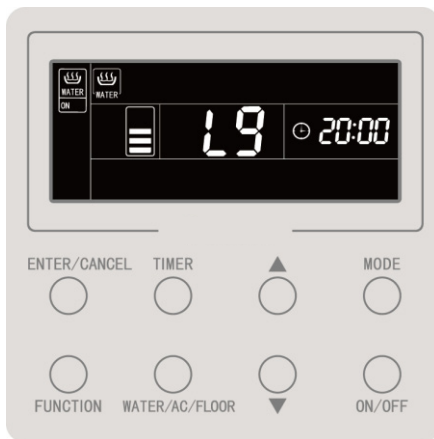
Figura 5.1: Error de número inconsistente de depósitos de agua o generadores de agua caliente para un sistema en que el controlador por cable controla varias unidades encendidas
