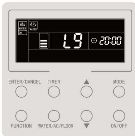
Figura 5.1 Errore di numero inconsistente di serbatoi d'acqua o generatori d'acqua calda in un sistema in cui il comando via cavo controlla diverse unità accese
