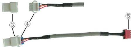
Fig. C: schema del cordone di connessione: il morsetto (3) è il terminale di protezione; collegare il morsetto ④ al morsetto ② del cavo di collegamento; collegare il morsetto ⑤ al morsetto del comando a filo del condizionatore d'aria
