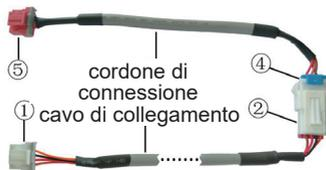
Fig. D: schema successivo al collegamento del cavo di collegamento e del cordone di connessione: collegare il morsetto ② del cavo di collegamento e il morsetto ④ del cordone di connessione
