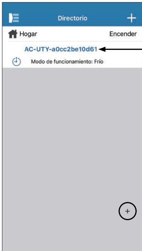
Aparecerá el estado de cada acondicionador de aire conectado. (Encendido/Apagado, Modo de operación, Temporizador, Error)
