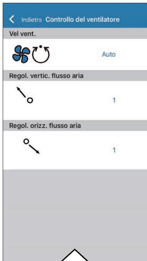
Selezionando ciascuna voce indicata sulla schermata, è possibile impostare la velocità del ventilatore e la direzione del flusso dell'aria.
