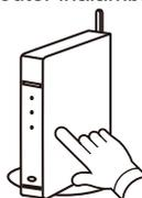
**6** Verifique que el LED 2 esté parpadeando. (Encendido/apagado en intervalos de 2 segundos.)
