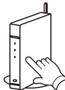
**6** Confirme se o LED 2 está a piscar. (Aceso/apagado em intervalos de 2 segundos.) Em seguida, prima continuamente o botão Definição no adaptador WLAN durante 3 segundos.
