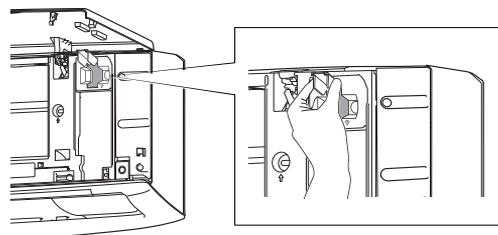
4. Conecte o adaptador W-LAN no slot de conexão da unidade interna na direcção como mostrada na figura.
