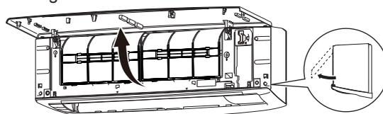
3. Abra a tampa do adaptador W-LAN até que ela se encaixe.
