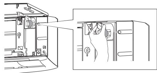
4. Stecken Sie den W-LAN Adapter in den Verbindungsanschluss des Innengerätes in Richtung wie auf der Beschreibung dargestellt.
