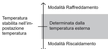
Quando viene selezionata la modalità Automatico per la prima volta, il ventilatore gira lentamente per alcuni minuti mentre l'unità interna rileva le condizioni della stanza e seleziona la modalità di funzionamento.
