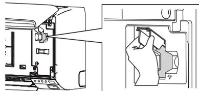
4. Branchez l'adaptateur W-LAN dans la fente de connexion de l'unité intérieure dans le sens indiqué sur la figure.
