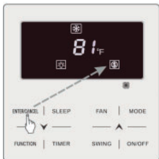
Fig.6.14: Ajuste de la función "Save" ["Ahorro"] para refrigeración en grados Fahrenheit
