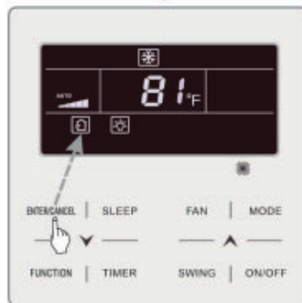
Fig. 6.12 Activación de la función "Air" ["Aire"] en grados Fahrenheit
