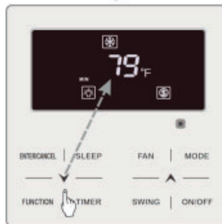
Fig.6.14: Ajuste de la función "Save" ["Ahorro"] para refrigeración en grados Fahrenheit
