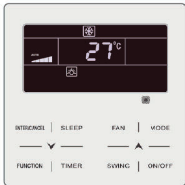
Fig. 6.1: Pantalla de estado de encendido en grados centígrados
