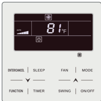
Fig. 6.3: Pantalla de estado de encendido en grados Fahrenheit
