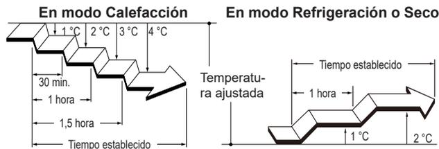
Una vez transcurrida la hora configurada, el acondicionador de aire se apaga.
