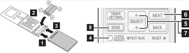
**1 ~ 3** Coloque las baterías tal y como se muestra en la figura de arriba.
