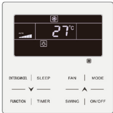
Fig. 6.1 Interfaccia dello stato di accensione in gradi Celsius
