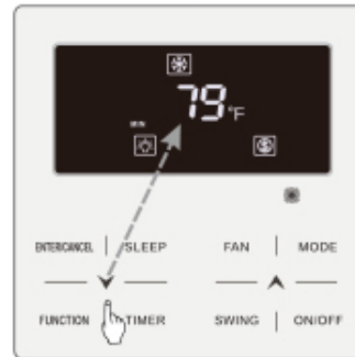
Fig.6.14 Impostazione della funzione di risparmio in modalità raffreddamento, in gradi Fahrenheit
