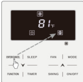
Fig.6.14 Réglage Save (Économies d'énergie) pour la climatisation en degrés Fahrenheit
