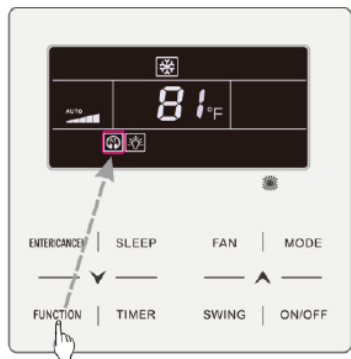
Fig. 6.9 Configuração da função de silêncio em Celsius
