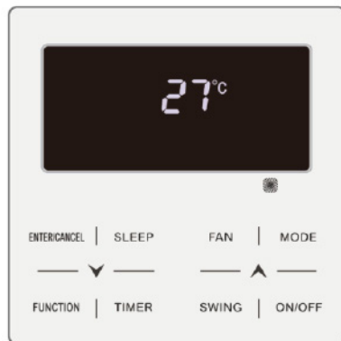
Fig. 6.2: Pantalla de estado de apagado en grados centígrados
