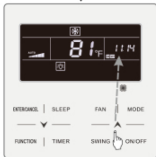
Fig. 6.8 Impostazione di accensione/spegnimento dell'unità con l'unità accesa, in gradi Fahrenheit
