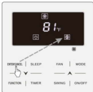
Fig.6.14 Impostazione della funzione di risparmio in modalità raffreddamento, in gradi Fahrenheit
