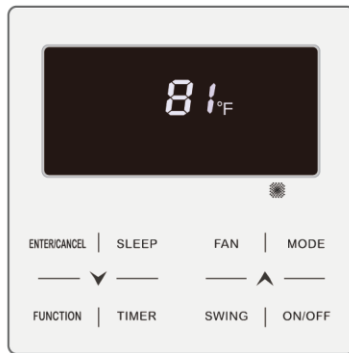
Fig. 6.4 Interface of Off status in Fahrenheit
