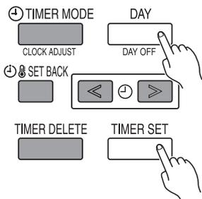
Die Tasten DAY/DAY OFF (Tag/ Tag aus) und TIMER SET (Zeitschalter einstellen) gleichzeitig mindestens 2 Sekunden lang drücken, um die Kindersicherung einzuschalten und alle Tasten der Fernbedienung außer der Tasten START/STOP (Start/ Stopp), SET TEMP. (Temperatureinstellung), MODE (Modus) und FAN (Lüfter) zu sperren. Drücken Sie die Tasten erneut für 2 Sekunden oder länger, um die Kindersicherungsfunktion zu deaktivieren.
