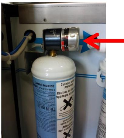
2. Per ottenere un'acqua più gassata occorre girare in senso orario il pomello di regolazione del riduttore. *Seguendo le preferenze dei clienti la regolazione è tra 3 e 4 bar.*
