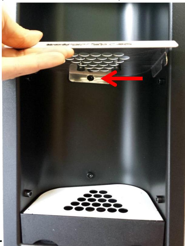
La griglia di supporto presenta due "arresti" in gomma che guidano il posizionamento del bicchiere. Se necessario gli "arresti" possono essere rimossi:
