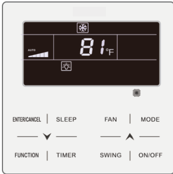
Fig. 4.3 Interface of On status in Fahrenheit
