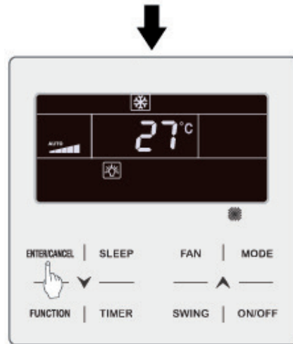
Fig. 4.8: Attivazione della funzione Filter Cleaning Reminding ["Promemoria pulizia filtro"]
