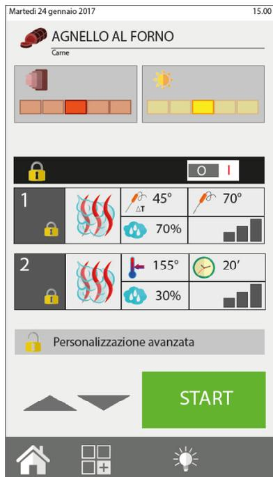
la fase de mantenimiento, que se podrá configurar en "INFINITO" para después tener una o varias fases sucesivas que, sin embargo, deberán ponerse en marcha manualmente. Por ejemplo: en la cocción nocturna de algunos asados se prefiere dorar el asado cuando el operador regresa a la cocina, así pues, después de la fase de mantenimiento.
