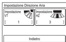
Quando l'unità interna non ha una funzione di regolazione della direzione orizzontale del flusso d'aria, [Impostazione HZ] non viene visualizzato e la direzione del flusso d'aria non può essere impostata.
