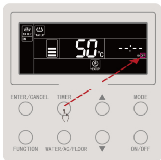
Prima o botão "TIMER" (Programador) para mudar para o programador de desativação do aquecimento de água
