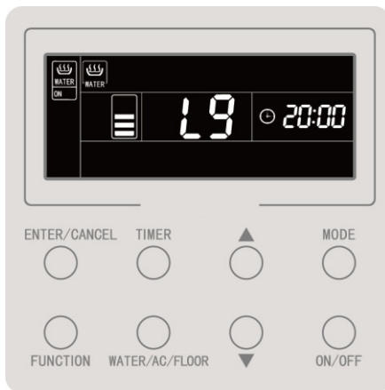
Figura 5.1 Erro de número inconsistente de depósitos de água ou geradores de água quente para um sistema que controla vários no estado ativado
