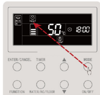
Prima o botão "MODE" (Modo) para mudar para o modo predefinido
