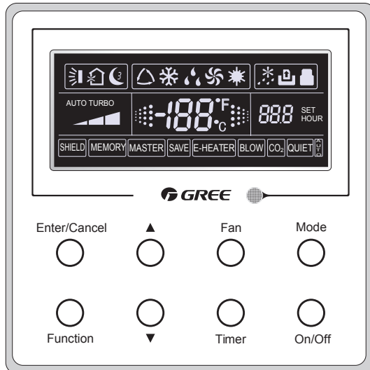
Fig.1 Vue extérieure du contrôleur à distance câblé
