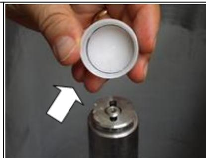
Desapertar o parafuso que fixa a gaiola de proteção do rotor do agitador da cuba e rodá-la em sentido anti-horário para liberá-la das ranhuras de fixação. Remover a gaiola de proteção.
