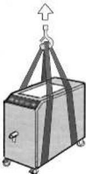
Levantar a máquina com correias, mantendo-as como mostrado na figura, perto das rodas dianteiras e traseiras. O tirante que levanta a máquina deve posicionar-se no seu centro exato.
