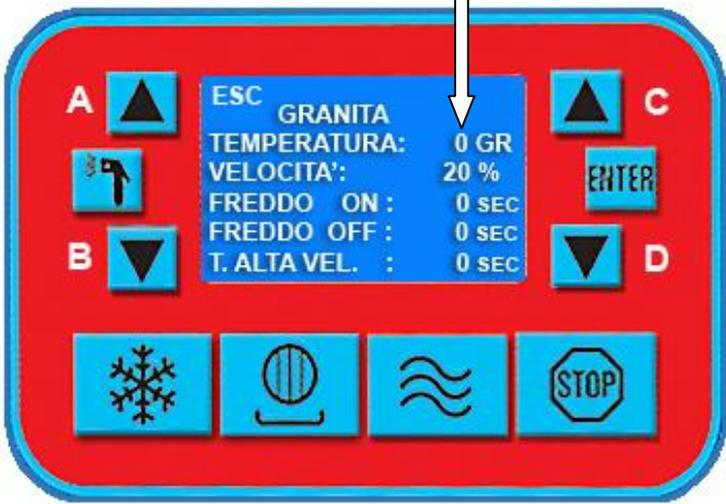
Pressionar qualquer uma destas teclas e aparece a segunda página dos **MODOS** para controlar o sorvete:
