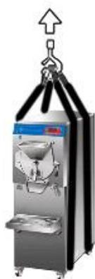
Levantar a máquina com correntes, mantendo-as como mostrado na figura, perto das rodas dianteiras e traseiras.
