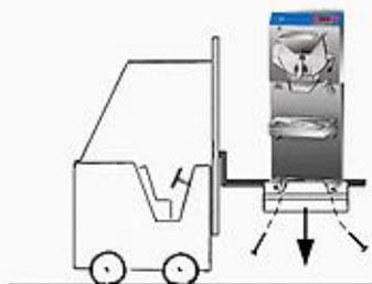
Desparafusar de baixo da base da caixa os quatro parafusos que mantêm a máquina parafusada e bloqueada.
