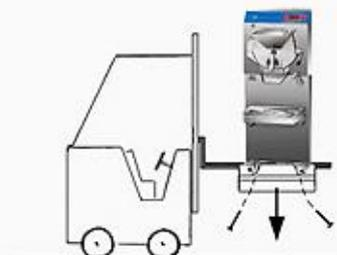
Svitare da sotto la base della cassa i quattro bulloni che tengono avvitata e bloccata la macchina.
