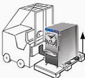
Sollevare la macchina con un carrello elevatore infilando le pale di sollevamento tra il fondo della macchina e la base della cassa.
