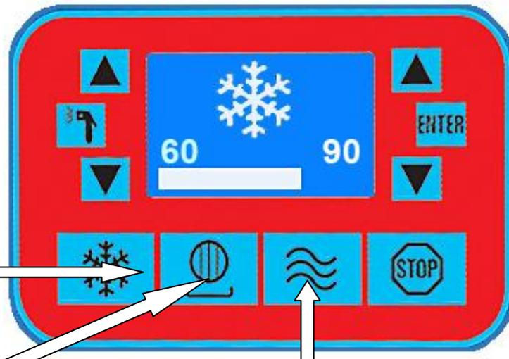
Si l'on souhaite retirer la glace à vitesse réduite et sans la refroidir, appuyer sur cette touche. Après 20 secondes, elle s'arrête. Si cela n'était pas suffisant, appuyer à nouveau.
