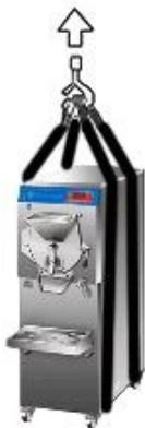
Soulever la machine avec des sangles, en la tenant comme cela est illustré dans la figure, à proximité des roues avant et arrière.
