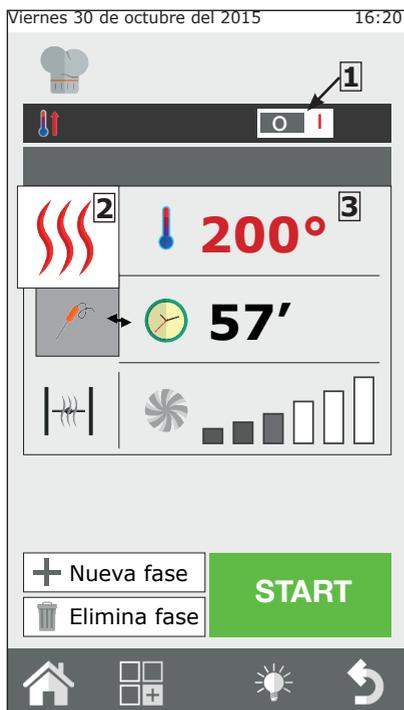
En cocción "Manual" será posible configurar el horno para una cocción individual con una o varias fases y/o configurar un programa de cocción y salvarlo en los recetarios "Tipo de cocción" y/o "Recetario clásico".
