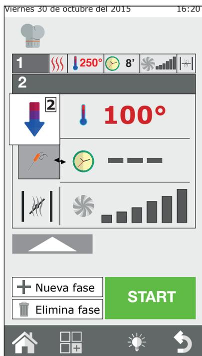
Entre una fase de cocción y otra podría ser necesario enfriar la temperatura de la cámara del horno. Por ejemplo, al cocer un asado es necesario enfriar la cámara entre la fase de dorado (a alta temperatura) y la fase de cocción (a baja temperatura).
