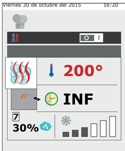
Para configurar el grado de humedad deseado pulse el botón **7** y configure el valor.
