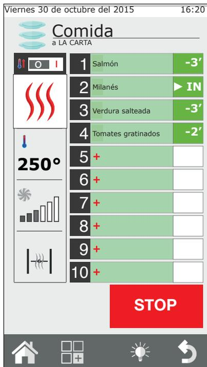
En los demás niveles se evidencia en verde el tiempo residual de horneado. El horno avisa de la misma manera cuando deben hornearse los demás platos. La señal acústica empieza de manera intermitente a partir de -15 segundos. Se aconseja esperar a que el temporizador llegue a 0 y se visualice el mensaje "IN" antes de hornear. De esta forma todos los platos se cocerán a la vez.
