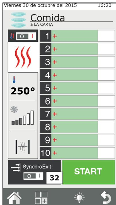
Una vez finalizado el precalentamiento (si presente) el horno avisa que hay que hornear los platos con el tiempo de cocción más largo. El aviso se efectúa mediante la señal acústica y el mensaje "IN" en la casilla derecha. Con la apertura y el cierre de la puerta la señal acústica se reajusta y parte la cuenta atrás.
