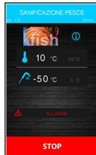
Le cycle d'assainissement commence par la phase de refroidissement rapide. Lorsque la température relevée par la sonde aiguille atteint celle de fin de refroidissement rapide, le dispositif passe automatiquement à la phase de maintien. La température de fin de refroidissement rapide (établie par le paramètre r20) représente aussi la valeur de travail pendant le maintien.
