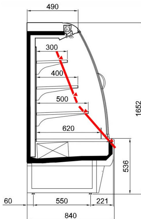
**NOTA:** El funcionamiento del mueble está garantizado en las condiciones climáticas indicadas en la placa matrícula y según las normas ISO 23953-2 si está cargado uniformemente no más allá de la línea de carga adecuada en cada mueble.
