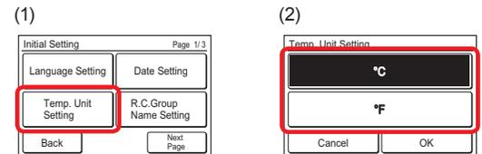
Quando [OK] for tocado, após um ecrã de alteração de definições ser exibido, o visor retorna para o ecrã "Initial Setting".
