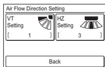
Quando a unidade interior não possui uma função de ajuste de direção de fluxo de ar horizontal, [HZ] não é mostrado e a direção do fluxo de ar não pode ser definida.
