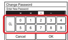
Quando a nova senha for inserida e [OK] for tocado, após o ecrã de alteração de definição ser exibido, o visor retorna para o ecrã "Password Setting".
