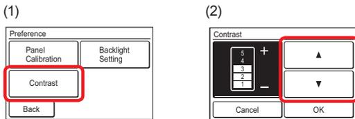
Quando [OK] for tocado, após o ecrã de alteração de definições ser exibido, o visor retorna para o ecrã "Preference".
