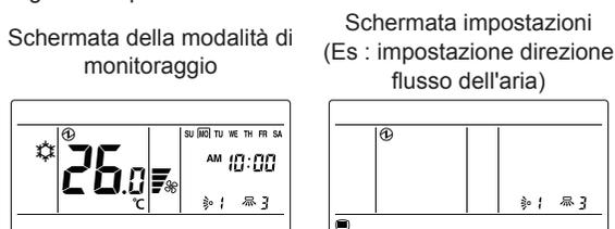
“Schermata della modalità di monitoraggio” è la schermata iniziale dell'unità. L'operazione di base è eseguita nel display della schermata.
