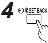
Pulse el botón “
