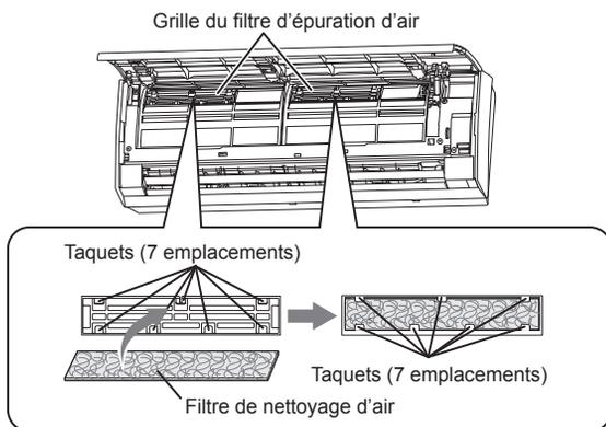
Il est possible d'attacher les nouveaux filtres de nettoyage de l'air sur le cadre droit ou le cadre gauche.
