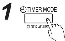
Premere il tasto TIMER MODE (CLOCK ADJUST) (MODALITÀ TIMER (REGOLAZIONE DELL'OROLOGIO)) per almeno 2 secondi. L'indicazione dell'ora sul telecomando lampeggia.
